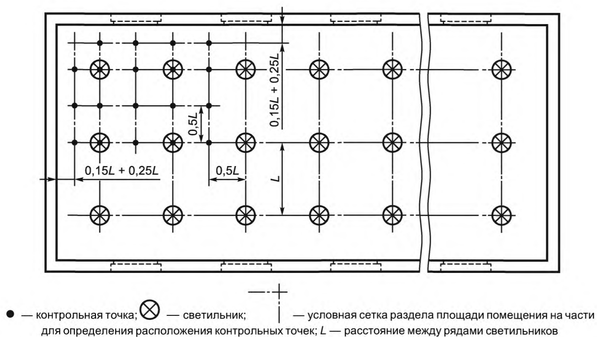
Рисунок Б.1 — Расположение контрольных точек при измерении минимальной освещенности помещения от светильников, принимаемых за точечные излучатели
